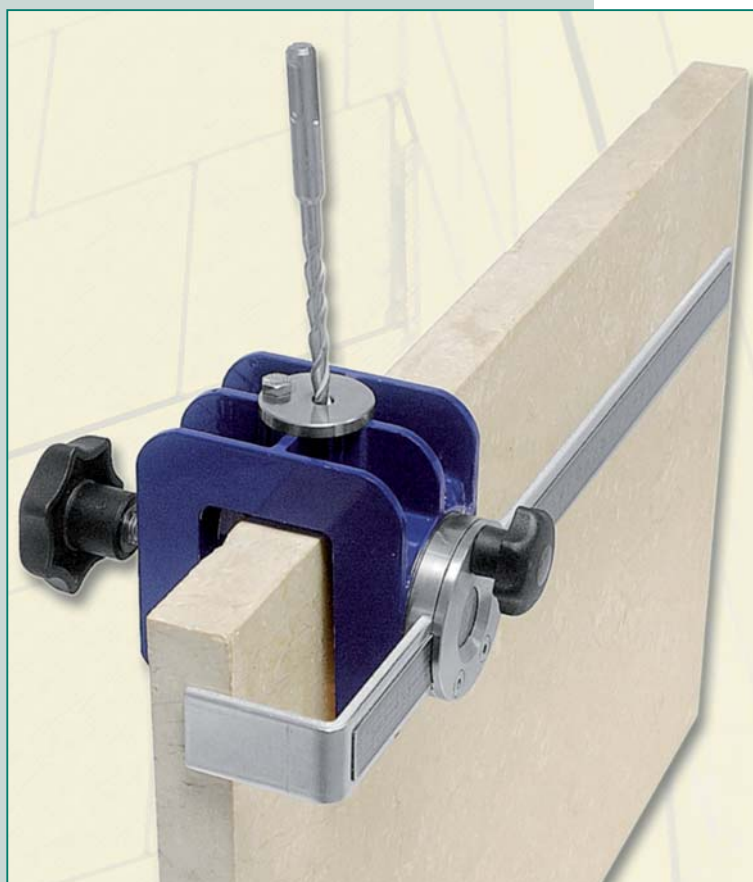
Photo Etanco : Exemple de gabarit de perçage des trous des chants des plaques.
