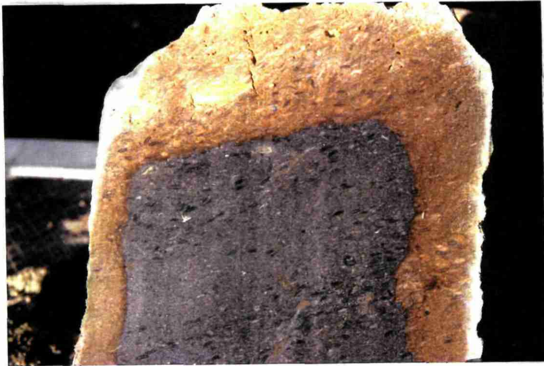
Ph. 1 : bloc de calcaire cimenté du site de Mousserolles-Hillans scié ; noter la frange d'altération et la couleur grise au centre (hauteur sur photo environ 18 cm)
