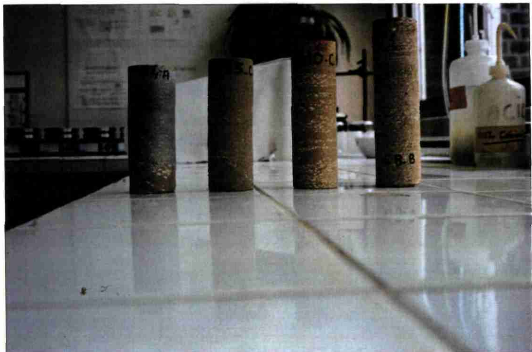
Ph. 2 : éprouvettes taillées dans les échantillons MH 4 et MH 5 (site de Mousserolles) et dans les blocs ouvrés MO et CB 1 (hauteur 10 à 15 cm)
