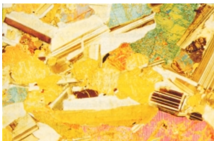
Fig. 4 Analyse microscopique d'un 'granit' noir Impala-Rustenburg importé d'Afrique du Sud (voir fiche n° GR6, p. 120). Ce granit est un norite (gabbro) composé principalement de pyroxènes (cristaux colorés) et de feldspaths (blanc-gris-noir).
