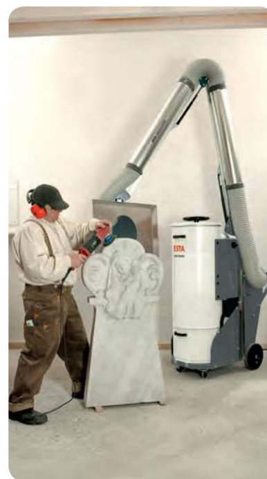
DUSTOMAT-16 M – Aspiration à la source de fines poussières issues du travail de la pierre
